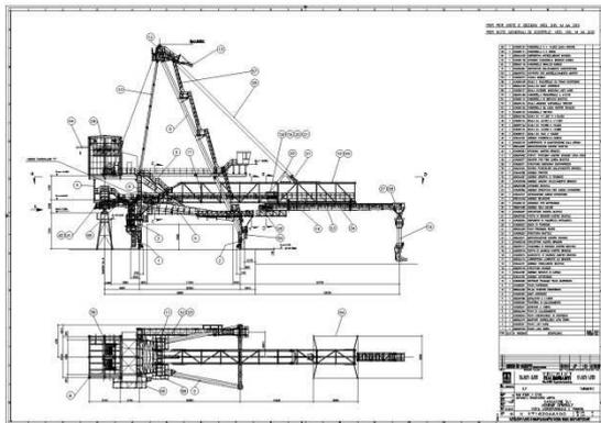
Per conto di Techint Italimpianti abbiamo sviluppato la progettazione strutturale del caricatore per navi dell'impianto di trasporto loppa d'altoforno nel centro siderurgico di Taranto.
