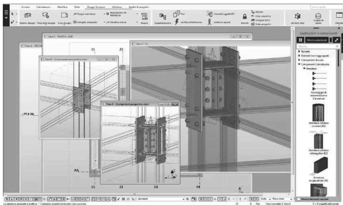
Dettagli in TEKLA Structures della struttura dell'Edificio Servizi
