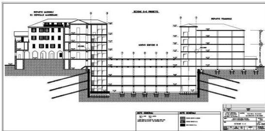
Nell'ambito della più vasta ristrutturazione dell'intero complesso, al fine di adeguarlo alle disposizioni delle più recenti normative riguardanti le Residenze Sanitarie, è stato predisposto un progetto che prevedeva la nuova costruzione di un edificio, interrato su tre lati, sul sedime di collegamento tra il vecchio reparto maschile e quello femminile. Ci siamo occupati della progettazione strutturale.
